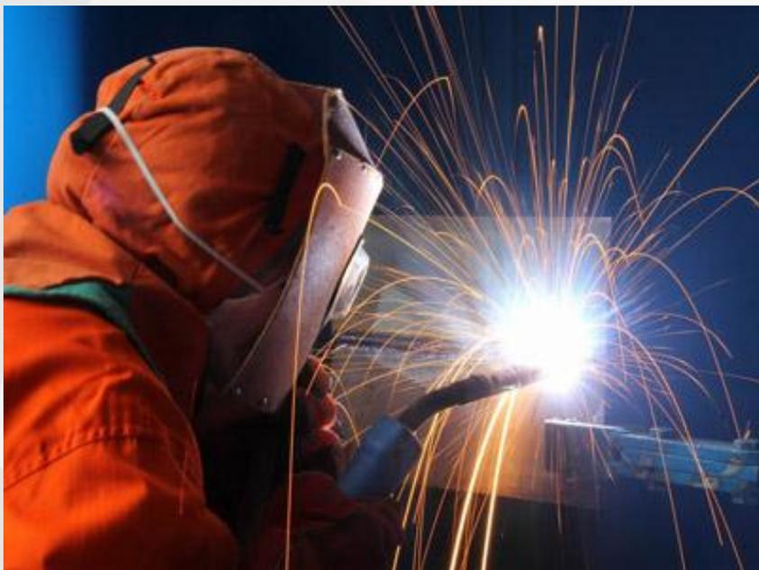
焊接是一种重要的金属机械加工工艺方法，其作业过程中产生的火花、有害气体、有害光线、噪音容易导致烧伤、触电、中毒、缺氧甚至火灾或爆炸等一系列安全隐患，随着自动化加工及智能制造技术的进步，智能焊接已经逐渐取代了人的现场作业，逐渐提高了作业效率，减少了安全隐患。智能焊机虚拟仿真实验旨在提高学生在焊接方面的综合素质，着重使学生掌握焊接作业所必备的专业知识和基本技能，
